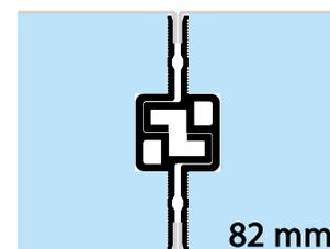
El panel autoportante fabricado por Camidix presenta un sistema de unión que garantiza un buen ajuste y drenaje dándole mayor resistencia y robustez al panel.
