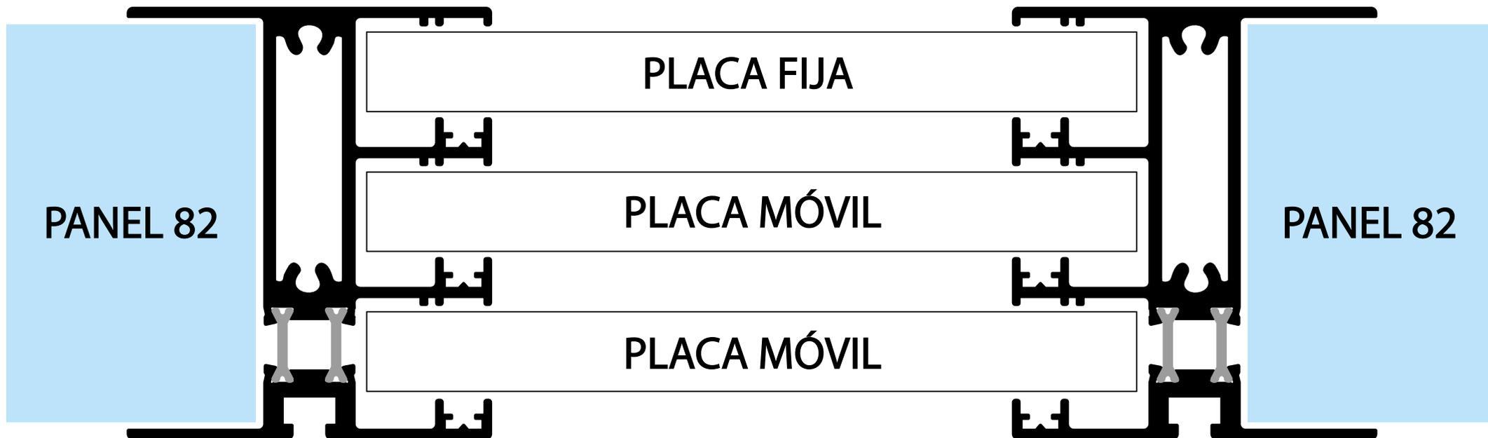
Combina la entrada de luz natural, espacio ventilado y conservando el aislamiento térmico. Su diseño mantiene la estética lisa por debajo. De apertura manual y fácil instalación. Compuesto por el perfil 3 carriles RPT, transversales y policarbonato translúcido.
